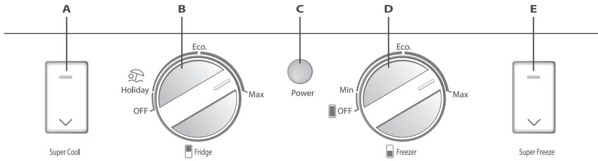
A – кнопка включения режима быстрого охлаждения (обозначение на панели управления SUPER COOL)
